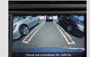
**Bleiben Sie im Bild.** Die Rückfahrkamera macht enge Parklücken besser einsehbar. Das Display auf dem Armaturenbrett zeigt Ihnen, was sich hinter Ihrem Fahrzeug befindet, und blendet Einpark-Führungslinien ein. Zusammen mit den zwei asphärischen Weitwinkel-Außenspiegeln haben Sie alles, was Sie für bessere Rundumsicht, sicherere Spurwechsel und leichtes Einparken benötigen.
