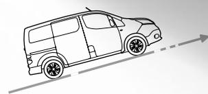
**Berganfahrhilfe.** Wenn Sie an einer Steigung angehalten haben und wieder losfahren wollen – kein Problem. Die Berganfahrhilfe hilft dabei, dass Sie nicht zurückrollen, indem sie den Bremsdruck für ein paar Sekunden aufrechterhält und Ihnen so Zeit gibt, vom Brems- auf das Gaspedal zu wechseln.
