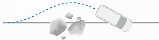
**ESP.** Die elektronische Stabilitätskontrolle macht plötzliche Spurwechsel und scharfes Bremsen zu reibungsloseren Vorgängen.
