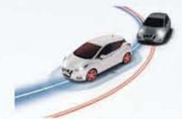
**MIT DER INTELLIGENTEN SPURKONTROLLE** behalten Sie jederzeit die Kontrolle. Das System bremst in Kurven die kurveninneren Räder leicht ab und sorgt so für ein agileres und sichereres Fahrverhalten.
