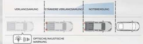
**Autonomer Notbrems-Assistent.** Dieses radargestützte System, im vorderen Stoßfänger eingebaut, misst den Abstand zum vorausfahrenden Fahrzeug. Erkennt es eine Kollisionsgefahr, gibt es eine akustische und optische Warnung aus. Falls der Fahrer nicht stark genug abbremst, bremst das Fahrzeug automatisch stärker, um einen Unfall zu verhindern. Das System arbeitet bei allen Geschwindigkeiten und bringt das Fahrzeug bei bis zu 30 km/h ohne Kollision zum Stillstand.
