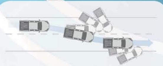
**Fahrdynamikregelung (Vehicle Dynamic Control – VDC).** VDC überwacht Ihre Lenkbewegungen, Bremsmanöver und die Fahrzeugstabilität und reduziert – falls notwendig – die Motorleistung und bremst bestimmte Räder ab, um Sie auf Ihrem eingeschlagenen Weg zu halten.
