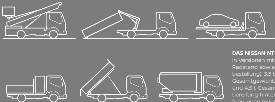
**DAS NISSAN NT400 FAHRGESTELL** gibt es in Versionen mit 2,50 m, 2,90 m und 3,40 m Radstand sowie mit 2,8 t, 3,2 t (beide Sonderbestellung), 3,5 t und 4,5 t zulässigem Gesamtgewicht. Die Ausführungen mit 3,5 t und 4,5 t Gesamtgewicht sind mit Zwillingbereifung hinten ausgestattet. Die Ausführungen mit 2,90 m und 3,40 m Radstand sowie 3,5 t und 4,5 t Gesamtgewicht sind auch mit Doppelkabine erhältlich.
