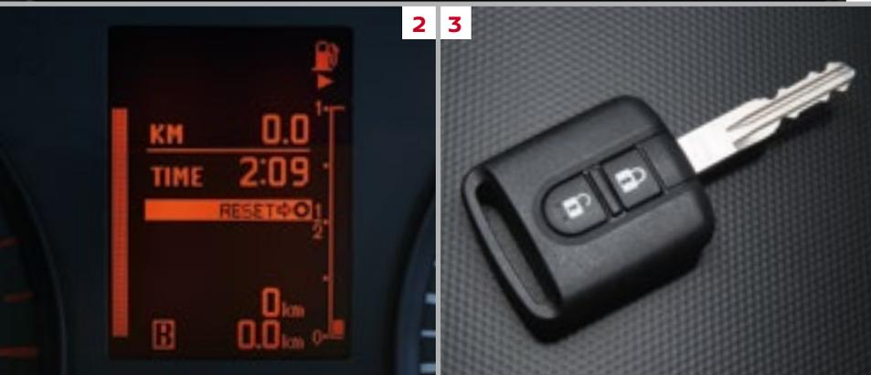
**2. MIT DEM BORDCOMPUTER** sind Sie über alles informiert. Die Ölwechselüberwachung OCS (Oil Change Supervisor) prüft die Ölqualität und zeigt an, wie viele Kilometer bis zum nächsten Ölwechsel verbleiben. Weitere Anzeigen: der durchschnittliche und aktuelle Kraftstoffverbrauch, die verbleibende Kraftstoff- und AdBlue®-Menge, Gesamtfahrzeit und -strecke, Durchschnittsgeschwindigkeit, ein Inspektionshinweis, ein Schaltsignal für optimale Gangwechsel, ein Tageskilometerzähler und eine Digitaluhr.
