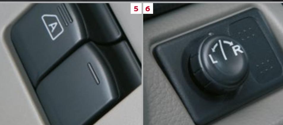
**5. ELEKTRISCHE FENSTERHEBER VORN** mit Impulsfunktion auf der Fahrerseite und Einklemmschutz gehören zur Serienausstattung des NISSAN NT400.
