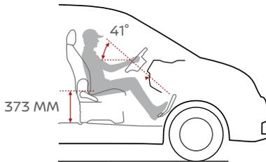
DIE FAHRPOSITION IM NISSAN NV200 IST HÖHER ALS BEI VERGLEICHBAREN MODELLLEN, DAMIT SIE WEITER VORAUSCHAUEN KÖNNEN. DIE INSTRUMENTE UND ANZEIGEN SIND IN FAHRRICHTUNG ANGEORDNET UND AUF EINEN BLICK ABLESBAR, DAMIT SIE SICH AUF DEN VERKEHR KONZENTRIEREN KÖNNEN.
