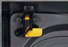
Dieses praktische Scharnier ermöglicht Ihnen, eine Hecktür offen zu arretieren und längere Ladung sicher zu transportieren.
