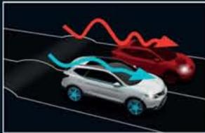
**AKTIVE FAHRKOMFORTREGELUNG** kompensiert durch weichen Bremsdruck die Wank- und Nickbewegungen des Fahrzeugs und sorgt so für einen höheren Fahrkomfort.
